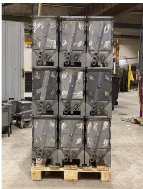
Questa stufa LIONS LCIF soddisfa tutti i requisiti necessari: è efficace, realizzata in acciaio, perfetta per riscaldare, ha un'ampia superficie per cuocere i cibi, è dotato di cassetto cenere per la raccolta della cenere e per il controllo del tiraggio, viene fornito con manuale di istruzioni incluso, sia in Inglese che Ucraino.
